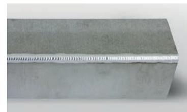
AC spécial – soudure sur coin extérieur, 3 mm
