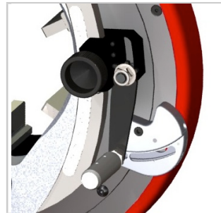
Système de suivi de profil extérieur: tient compte de l'ovalisation des tubes
