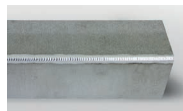
AC spécial – soudure sur coin extérieur, 3 mm
